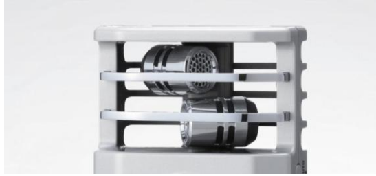
Eingebautes X/Y Stereomikrofon und Tiefenstaffelung
